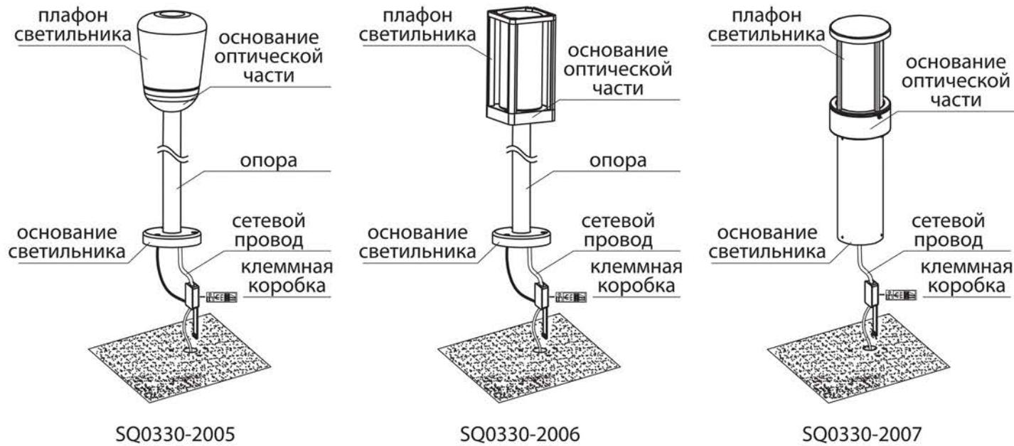
Рисунок 1. Конструкция светильников
