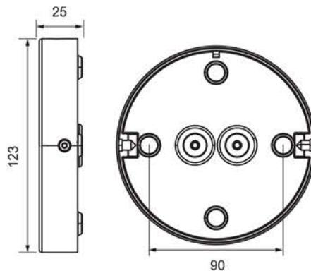
Рисунок 2. Основание светильника
