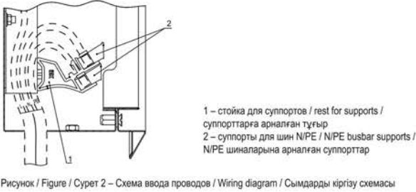
Рисунок / Figure / Сурет 2 – Схема ввода проводов / Wiring diagram / Сымдарды кірізу схемасы
