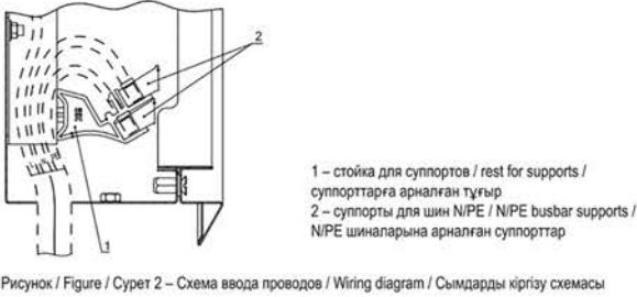
Рисунок / Figure / Сурет 2 – Схема ввода проводов / Wiring diagram / Сымдарды кіртізу схемасы
