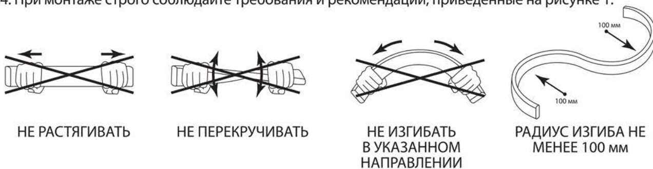
Рисунок 1. Требования и рекомендации для монтажа гибкого неона.
