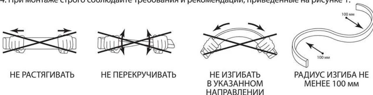
Рисунок 1. Требования и рекомендации для монтажа гибкого неона.
