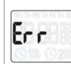
Сигнал ошибки внутреннего таймера PCZ. Она может быть вызвана внутренней неисправностью или ошибкой конфигурации, или может указывать на повреждение драйвера.
