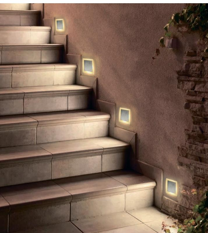
Встраиваемые светильники LN010, LN011 Feron со светодиодными источниками света предназначены для подсветки лестничного марша, стен и небольших декоративных ниш. Устанавливаются непосредственно в стены из кирпича или бетона.
