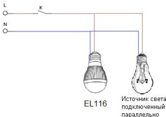
При пропадании напряжения питающей сети устройство управления светильника EL116 замыкает электрическую схему через прибор, подключенный параллельно на тот же фазный провод. В качестве подключаемого прибора, может использоваться лампа накаливания либо любая энергосберегающая лампа – светодиодная лампа или КЛЛ. Также, может использоваться светильник, либо любое другое электрооборудование (холодильник, микроволновая печь, телевизор и пр.).
