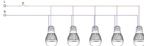
В этом случае устройство управления светильника EL116 замыкает электрическую схему через параллельно соединенный светильник.
