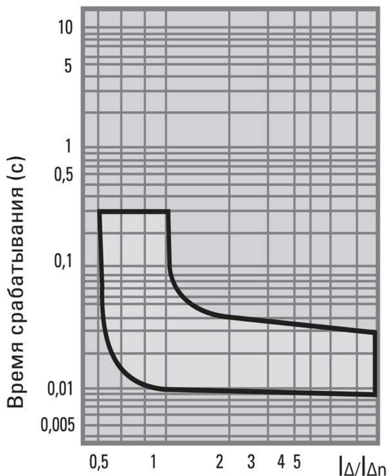
Рис. 1 - Время-токовые характеристики срабатывания дифференциальной защиты
