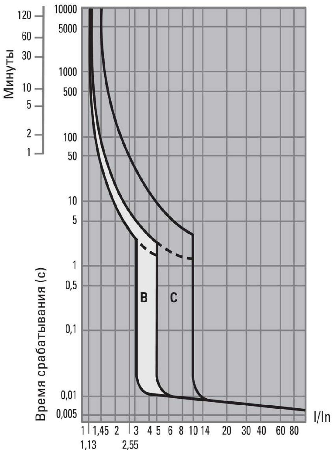
Рис. 2 - Время-токовые характеристики срабатывания
