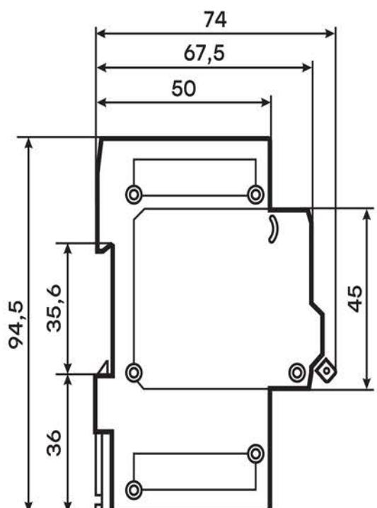
Рис. 3 - Габаритные размеры. Вар. 1
