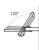
4. Закрепите болты кронштейна для фиксации прожектора
