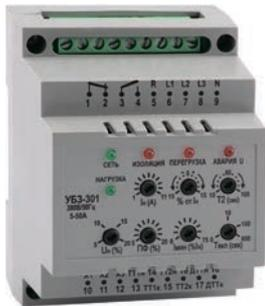
Универсальный блок защиты электродвигателей OptiDin УБЗ-301 (далее - блок) предназначен для постоянного контроля параметров сетевого напряжения и действующих значений фазных/линейных токов трехфазного электрооборудования 380 В/50 Гц, в первую очередь, асинхронных электродвигателей (ЭД), мощностью 2,5-315 кВт, в том числе и в сетях с изолированной нейтралью.
