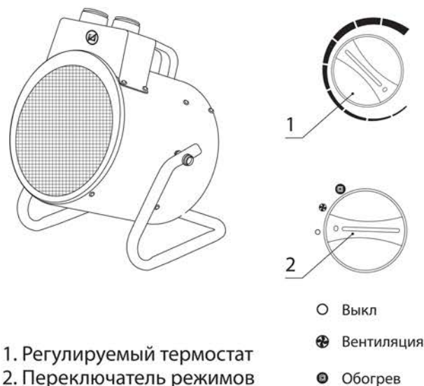
Рисунок 2. Тепловая пушка ТПК-О, устройство и органы управления
