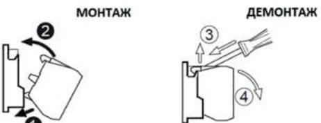
Монтаж и демонтаж контактного блока
