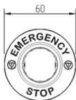
Масса – 0,004 кг Рисунок А.27 – Табличка с маркировкой «EMERGENCY STOP» OptiSignal D22 A45-MH2260
