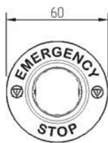
Масса – 0,004 кг Рисунок А.27 – Табличка с маркировкой «EMERGENCY STOP» OptiSignal D22 A45-MH2260
