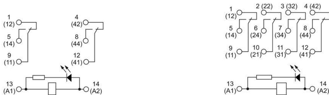
а) схема реле интерфейсного / diagram of the interface relay / интерфейс релесінің схемасы ORM-1-2C-DC24V-L-B, ORM-1-2C-AC220V-L-B
