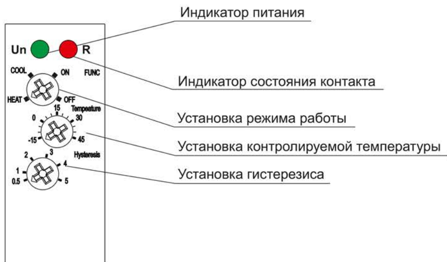
Рисунок 6 – Лицевая панель реле
