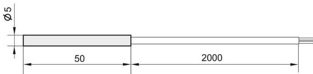
Рисунок 2 – Габаритные и установочные размеры датчика
