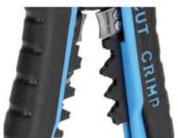
**Модуль для опрессовки WS-11.** Предназначен для опрессовки неизолированных гильз и наконечников сечением от 0,5 до 6 мм<sup>2</sup> (ГМЛ, ГМЛ(о), ТМ, ТМЛ, ТМЛ(о), автоклемм).
