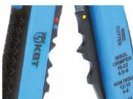
**Модуль для опрессовки WS-07, WS-17.** Предназначен для опрессовки изолированных гильз и наконечников сечением от 0,5 до 6 мм<sup>2</sup> (НКИ, НИК, НВИ, ГСИ, НШКИ, НШПИ, изолированных разъемов), а так же неизолированных гильз и наконечников, в том числе и автоклемм.
