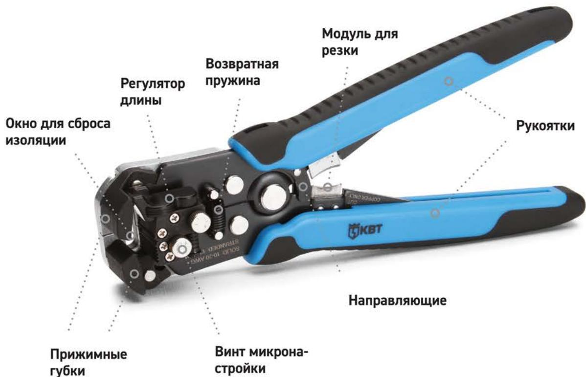
Автоматические стрипперы состоят из нескольких зияющих рукояток, прижимных губок, механизма микронастройки усилий прижима губок, а также дополнительных модулей для резки и опрессовки в зависимости от конкретной модели.
