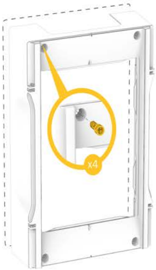
1.4 Крепление крышки к основанию Mount of the cover to the base
