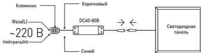
Рис.1. Схема подключения светодиодной панели к сети 220В.
