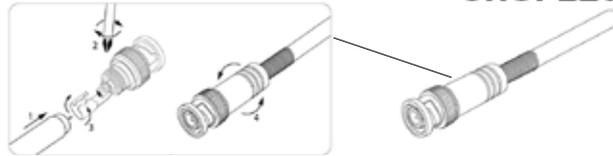
Предназначены для подключения коаксиального кабеля к видеокамерам, видеорегистраторам, мониторам и другим радиоэлектронным устройствам.
