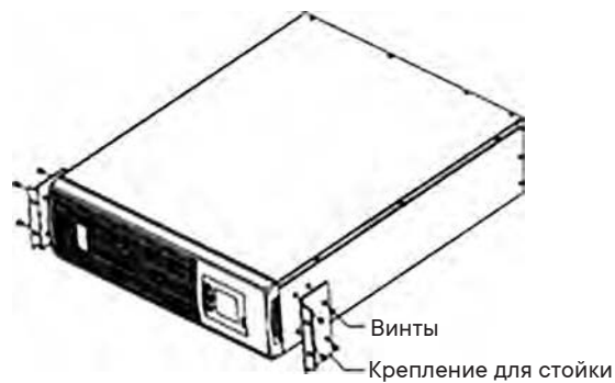
Рис. 6. Монтаж кронштейнов для установки в стойку
