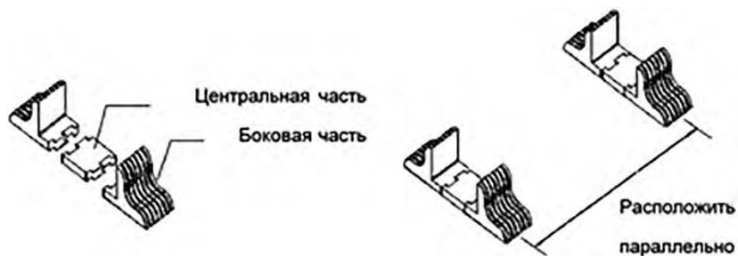
Рис. 4. Сборка и расположение опор
