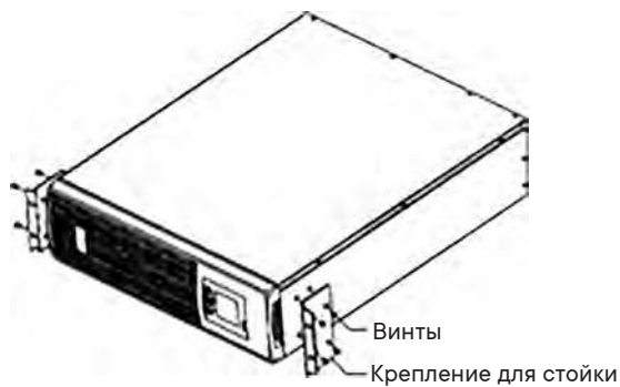
Рис. 6. Монтаж кронштейнов для установки в стойку
