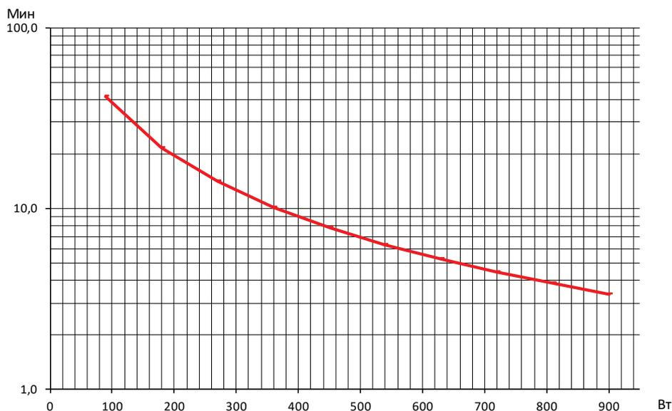
Рисунок 5. График времени автономной работы INFOLCD1500S / INFOLCD1500I
