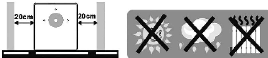
Рисунок 1. Расположение ИБП
