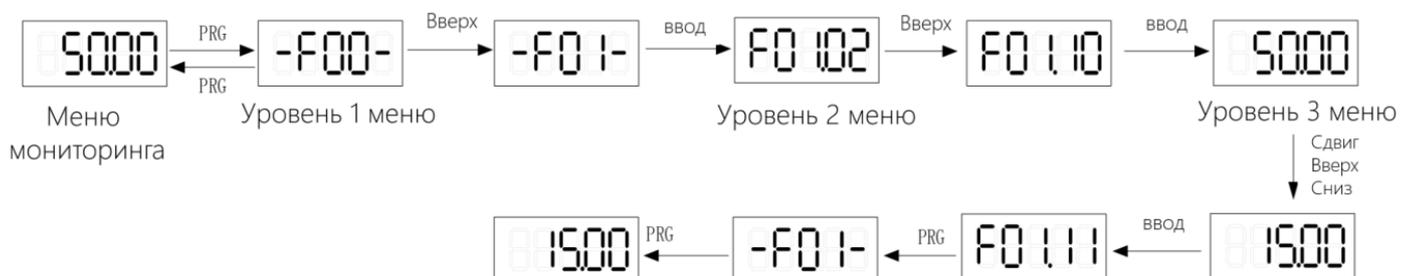
Рис. 4-5 Принципиальная схема изменения рабочей частоты
