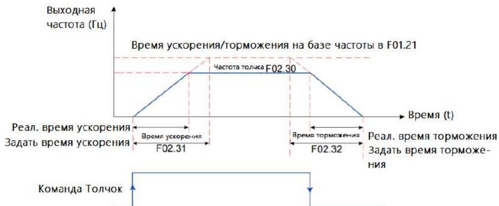
Рис. 5-21 Схема работы с толчковым режимом
