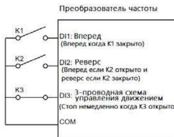
Рис. 5-3 Схема трехпроводной подключения 1
