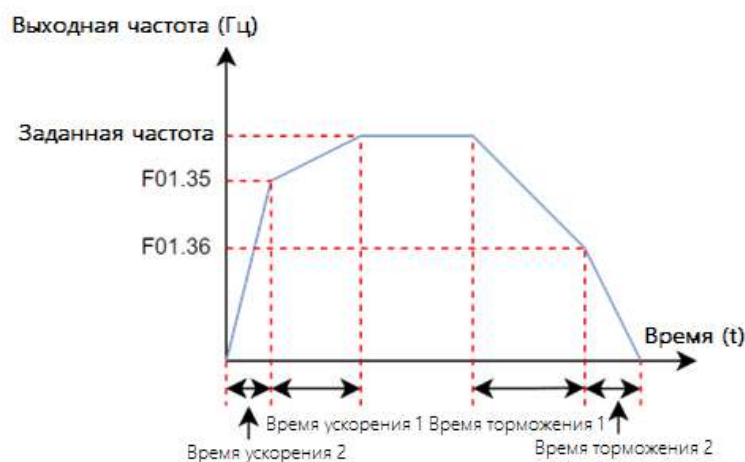
Рис. 5-31 Схема переключения времени разгона и торможения
