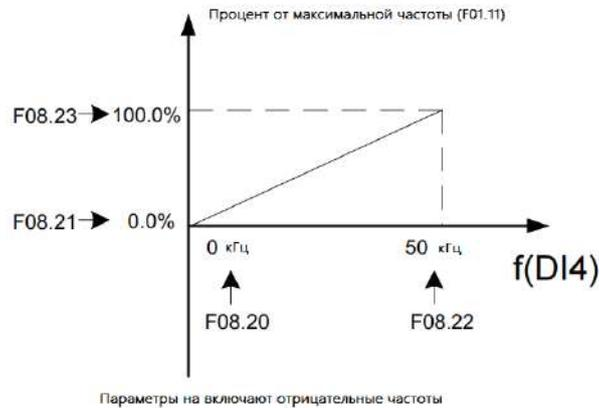
Рис. 5-13 Типичная кривая настройки, когда DI6 используется в качестве задания частоты.
