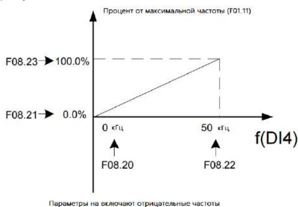
Рис. 5-13 Типичная кривая настройки, когда DI6 используется в качестве задания частоты.
