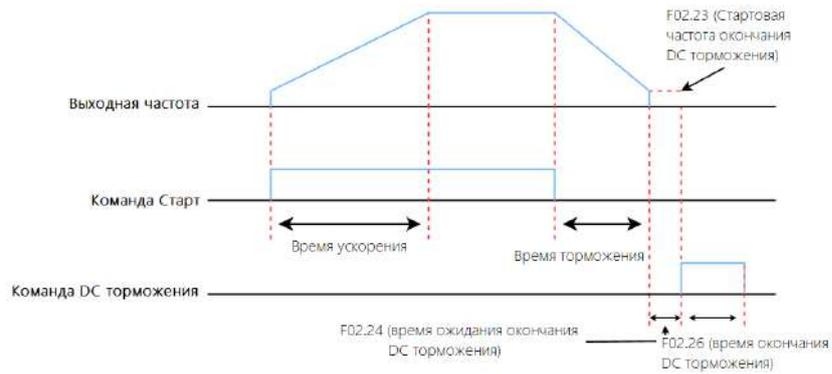
Рис. 5-27 Временная диаграмма торможения постоянным током при выключении
