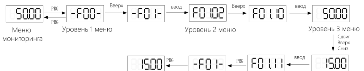
Рис. 4-5 Принципиальная схема изменения рабочей частоты
