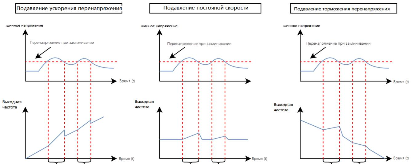
Рис. 5-37 Схема действий при остановке из-за перенапряжения
