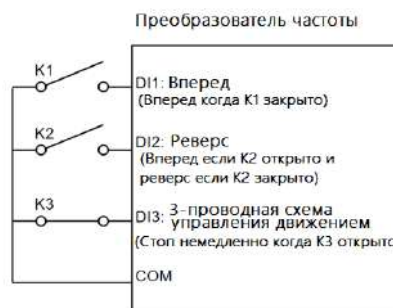
Рис. 5-4 Схема схема трехпроводного подключения 2
