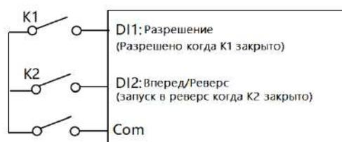
Рис. 5-1 Схема двухпроводного подключения 1
