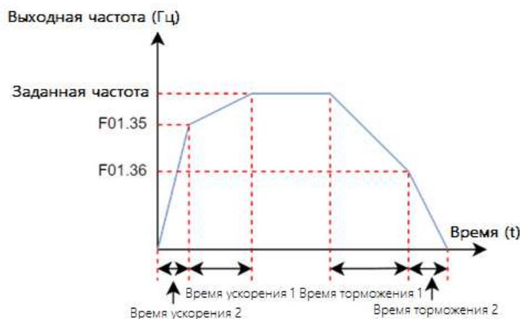
Рис. 5-31 Схема переключения времени разгона и торможения
