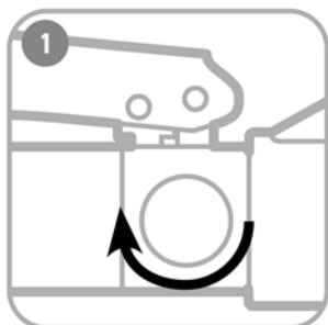
Поверните винт сброса давления в положение «Закрыть»
