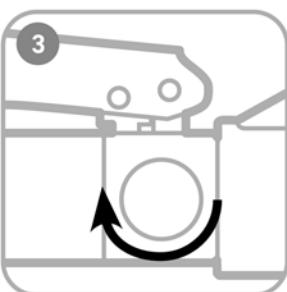
Поверните винт сброса давления в положение «Закрыть»
