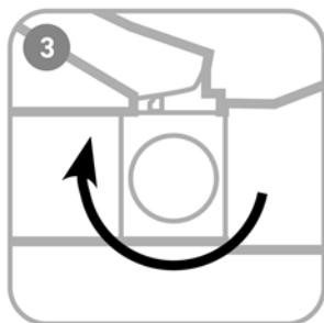
Поверните винт сброса давления в положение «Закрыть»
