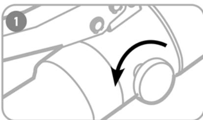
Поверните винт сброса давления
