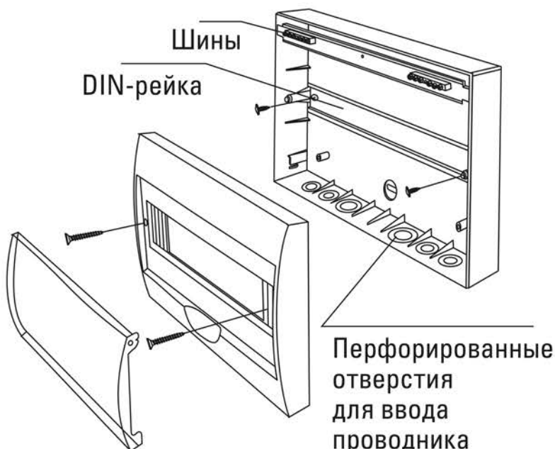
Рис. 2 - Схема монтажа ЩРН-П (принт дерево)
