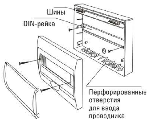
Рис. 1 – Схема монтажа ЩРН-П
