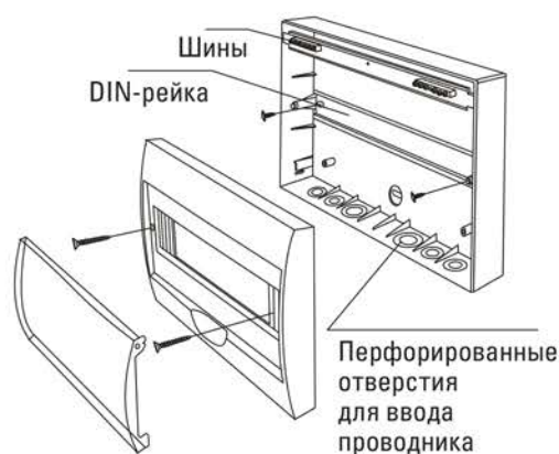
Рис. 1 – Схема монтажа ЩРН-П
