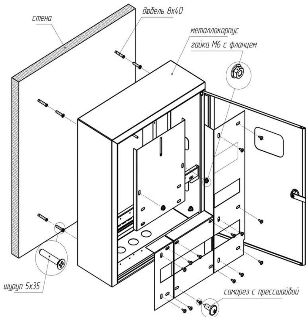
Рис. 1 - Схема монтажа
