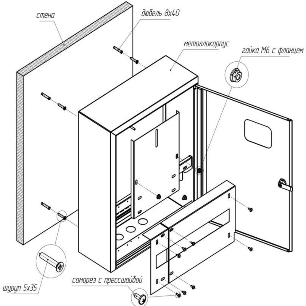
Рис. 1 - Схема монтажа
