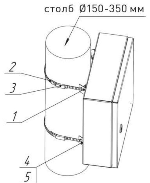
Рис. 1.2 - Схема монтажа на столб
