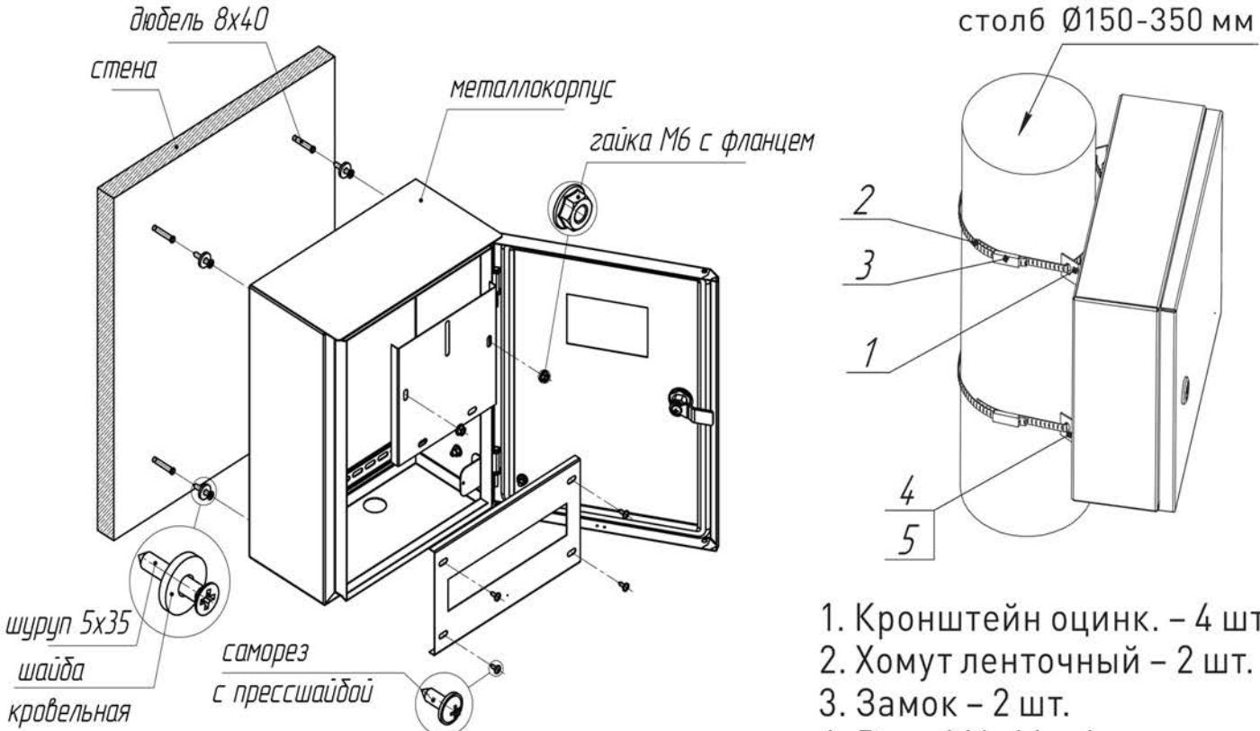
Рис. 1.1 - Схема настенного монтажа
