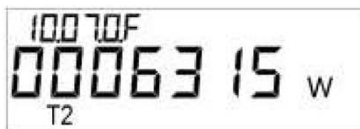
Рисунок 2.11 – Меню 6 кадр 1. Мощность активная, в Вт
