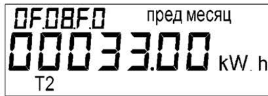
Рисунок 2.7 – Меню 1 Кадр 6. Энергия активная нарастающим итогом всего за предыдущий месяц, в кВт·ч
