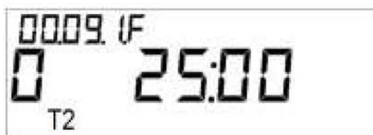
Рисунок 2.14 – Меню 7 кадр 3. Кадр ручной коррекции времени: 0 – коррекция запрещена, 1 – коррекция разрешена
