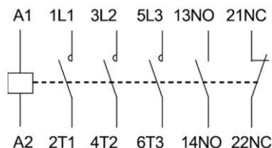
Рисунок 7. Схема подключения контакторов серии КМ-102 115-800А
