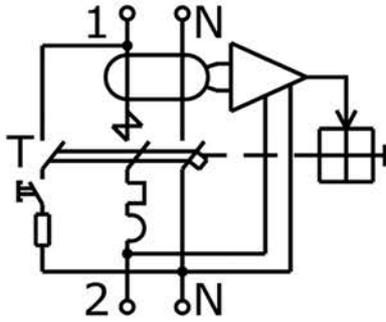
T – устройство эксплуатационного контроля (кнопка «ТЕСТ»)
