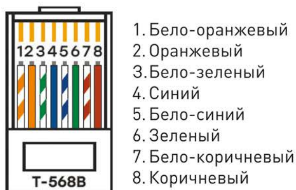
Рис. 6. Схема обжима проводников в соответствии с TIA 568B
