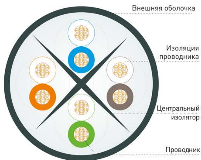
Рис. 3 – Конструкция патч-корда категории 6 типа U/UTP
