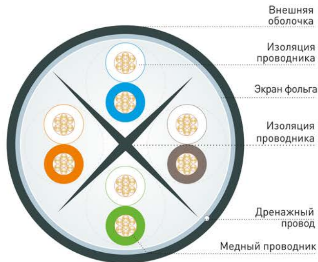
Рис. 4 – Конструкция патч-корда категории 6 типа F/UTP
