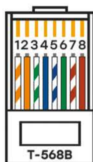
Рис. 4. Схема обжима проводников в соответствии с TIA 568B
