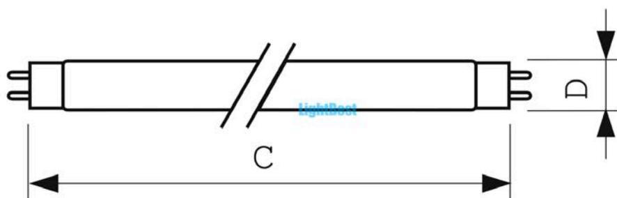
Лампа инсектицидная светодиодная в ловушки для насекомых LightBest LED BL 1,5W=15W 220V T8 G13
