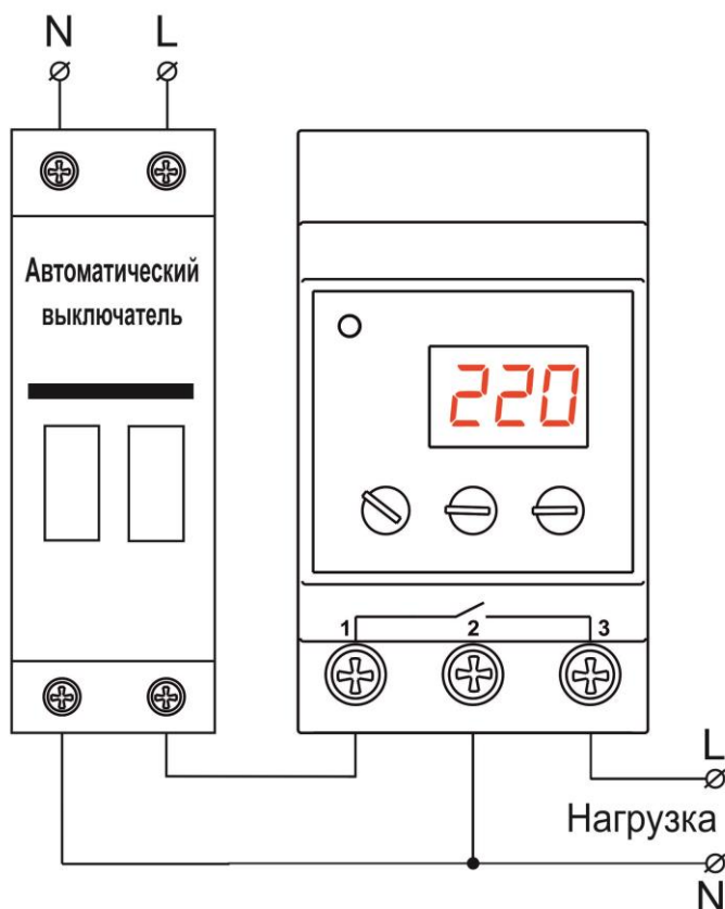
Рисунок 2 – Схема подключения изделия
