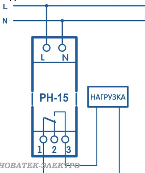
Для надежного контакта необходимо производить затяжку винтов клеммника с усилием 0,4 Н\*м.
