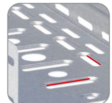
Продольная и поперечная подштамповка для увеличения площади охлаждения и придания дополнительной жесткости основанию лотка
