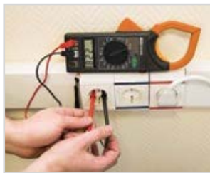
Измерение переменного тока и напряжения.
