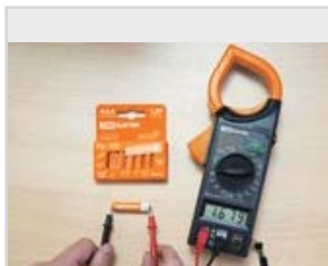
Измерение постоянного тока и напряжения.
