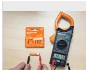
Измерение постоянного тока и напряжения.
