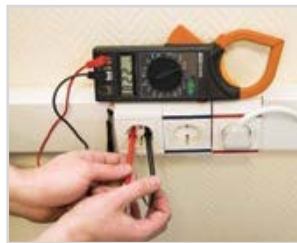
Измерение переменного тока и напряжения.
