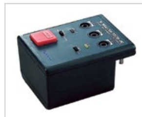
Токоизмерительные клещи могут производить измерение сопротивления изоляции при подключении дополнительного измерителя изоляции DT261.
