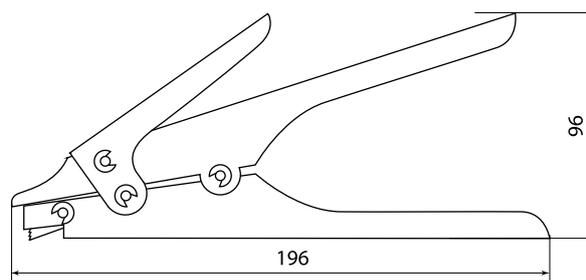
Инструмент для монтажа кабельных стяжек MX01
