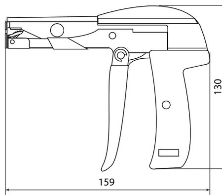
Инструмент для монтажа кабельных стяжек MX02
