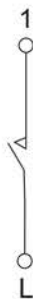
к) выключатель с самовозвратом / momentary contact switch / өзі қайтатын бір пернелі ажыратқыш / intrerupator singură automat cu resetare
