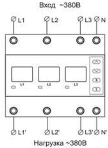
Рис.1. Схема подключения
